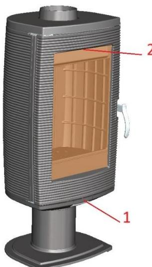
1. Подача первичного воздуха на колосник и во вторичную камеру дожига дымовых газов при розжиге (А) и управление горением в номинальном режиме (Б)
