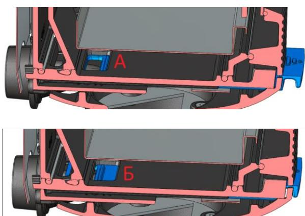
2. Подача воздуха дополнительного не регулируемого воздуха. **Подача вторичного воздуха уменьшает сажевые отложения на стекле и повышает качество горения.**
